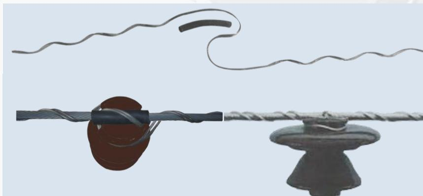
Se utilizan en el amarre de conductores desnudos de Aluminio y Aluminio/Acero a la cabeza del aislador a "Perno Fijo" Vanos hasta 90 mts
