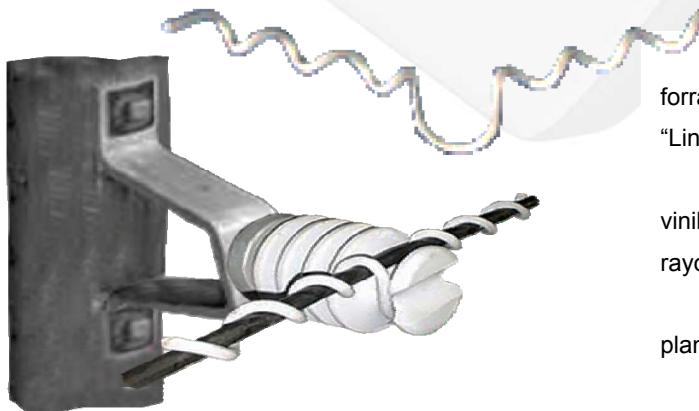
Son utilizadas para fijar conductores forrados o aislados a el cuello de aisladores tipo "Line Post"- (fijación lateral)
