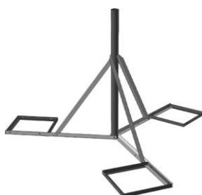
Permite tanto la instalación no-penetrante y/o penetrante según sea el sitio de instalación.- En lugares donde no se puede o no está permitida la perforación de la misma, adosando los 3 marcos en el extremo de cada pata, se complementan con suplementos de baldosón de Hº de 50x 40cm u otros elementos que cumplan la función de contrapeso.- Se instala en loza o suelo mediante la sujeción con brocas y si se desea la colocación de contra pesos.
